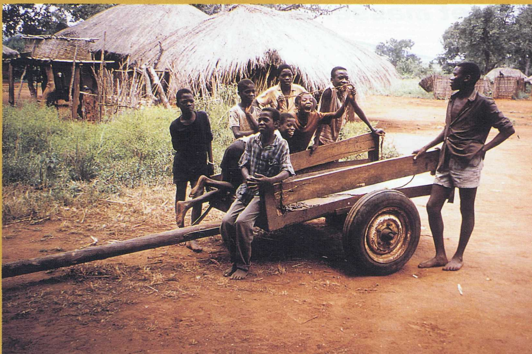
Ossenwagens waarvan de houten trekboom en zijwanden regelmatig vervangen worden. De rest van de kar is van staal.
